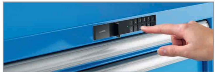
Code Lock-Schließsystem für Modell [1] und [2] Einfach zu bedienen, sofort betriebsbereit, mehrjährige Funktionalität ohne Batteriewechsel. • Schließung mit 10 Ziffern über einen 4 - 6-stelligen Code • Bis zu 100 verschiedene Codes möglich
